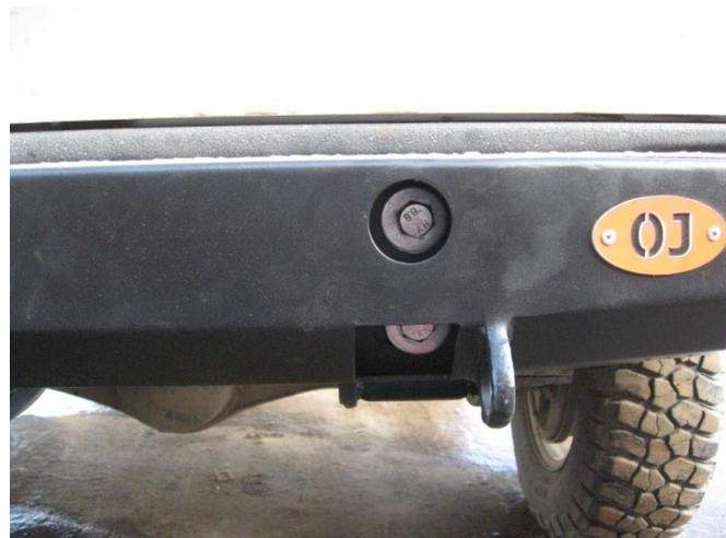
Навесить бампер на кронштейны, наживить болты крепления бампера к кронштейнам боковым (Болты М 14х40 4 шт) и центральному (Болты М 12х35 4 шт).
