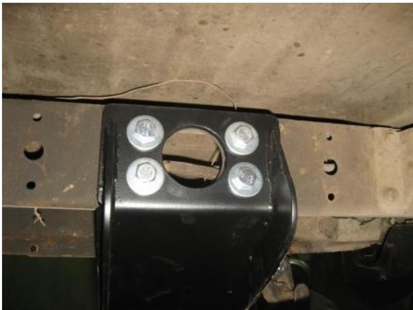
Наживить центральный кронштейн болтами М10х35, расположив его с внутренней части поперечины рамы.
