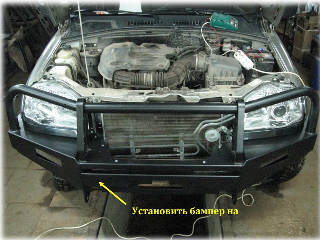
12. Установить бампер на автомобиль. "Наживить" гайки М10 крепления бампера (по 3 шт. на сторону). Под каждую гайку подложить увеличенную шайбу и стопорную шайбу.
