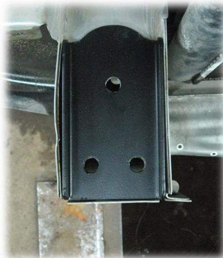
4. Установить накладки на правый и левый лонжероны, как показано на рисунке. Накладку необходимо установить в упор к отгибу на верхней полке лонжерона. Используя накладки как шаблоны, отметить и просверлить по 3 отверстия диаметром 11 мм в лонжеронах.
