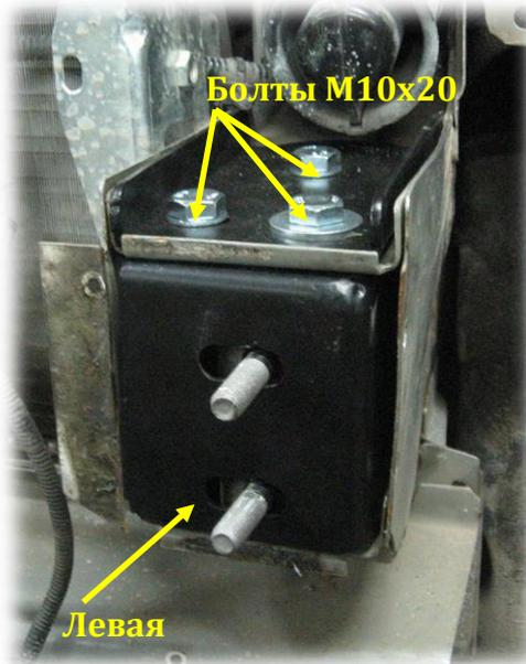
5. Установить закладные в полости лонжеронов и закрепить их с помощью болтов M10x20. Болты необходимо затянуть до упора.
