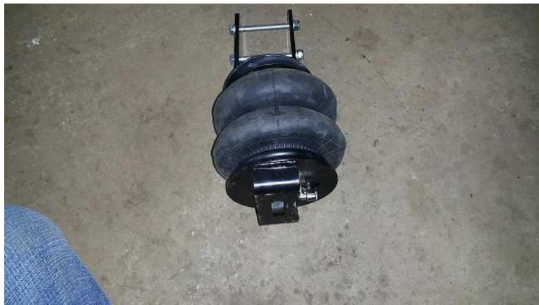
Треугольный вырез нижнего кронштейна также должен быть развернут к центру автомобиля.
